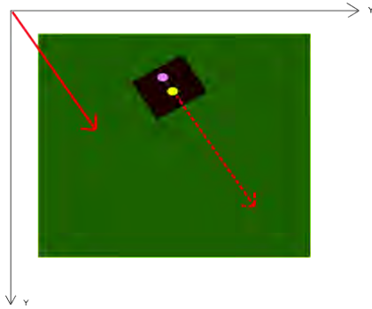
Fig. 3.2. Correspondencia de la orientación del robot con respecto a un sistema de coordenadas centrado en la esquina superior izquierda del robot.
